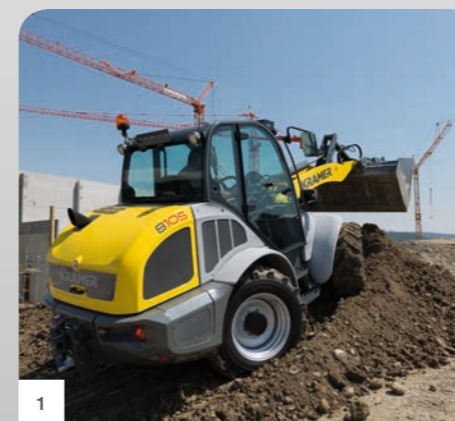
1 Standsicherheit selbst in unwegsamem Gelände: Der ungeteilte Rahmen schafft hohe Standsicherheit.
